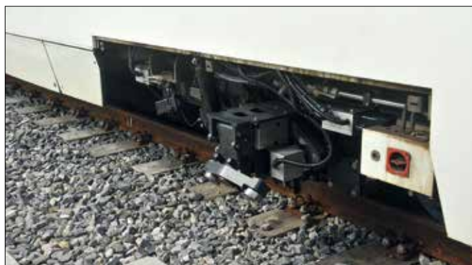
De g. à d. : gros plan sur le bogie, avec ses bras dépliés (à gauche), alors qu'un véhicule effectue, sur la rampe de changement d'écartement, une transition voie métrique-voie à écartement standard européen ; le même bogie avec bras repliés (Zweisimmen, 30 avril 2019).
