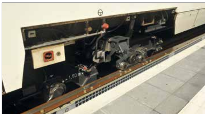
De g. à d. : gros plan sur le bogie, avec ses bras dépliés (à gauche), alors qu'un véhicule effectue, sur la rampe de changement d'écartement, une transition voie métrique-voie à écartement standard européen ; le même bogie avec bras repliés (Zweisimmen, 30 avril 2019).
